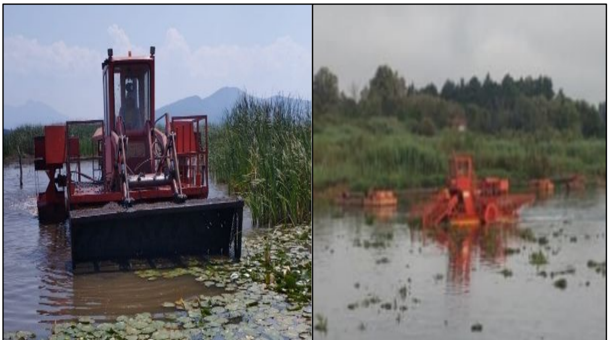
Imagen 3. Maquina desmalezadora, Aquadozer y Cosechador de maleza acuática Flotante
